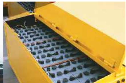
**Baterías para locomotoras mineras**
